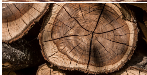
Fig. 19. Defecte de structură ale lemnului
