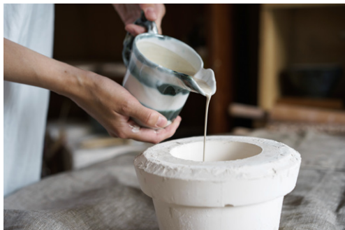
Fig. 22. Turnarea în forma de ipsos
