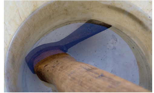
Fig. 6. Prin absorbția apei, lemnul își mărește volumul (se umflă)
