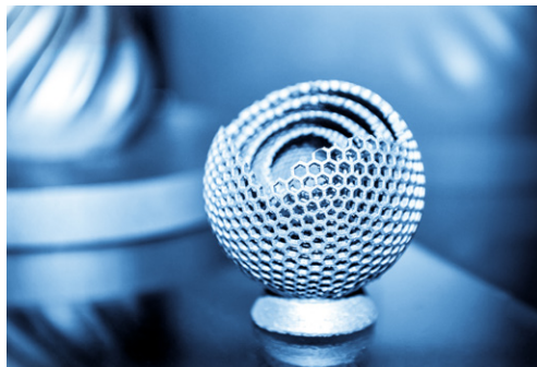
Fig. 46. Obiect metalic realizat prin adăugare de material la imprimanta 3D
