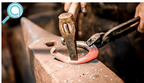
Fig. 29. Prelucrarea potcoavelor prin forjare la cald
