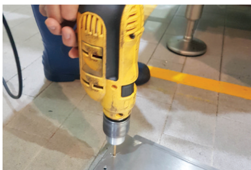
Fig. 20. Mașina de găurit electrică, acționată manual
