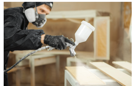
Fig. 27. Echipament de protecție recomandat la aplicarea vopselelor
